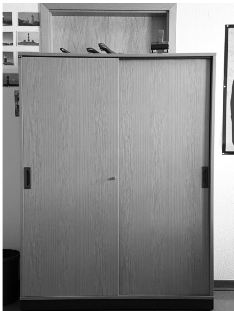
Abb. 3.6: Fluchtwege, wie hier eine Zwischentür zum Nachbarbüro, sollten nicht zugestellt werden. (Foto: Andreas Kohl)
